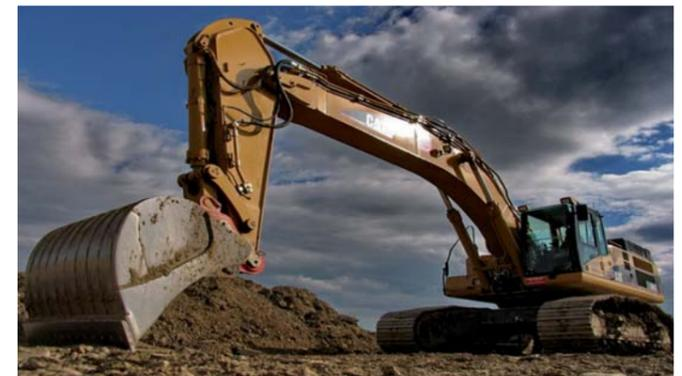
stärker. Ein moderner Bagger zeichnet sich durch einen um 360° drehbaren Aufbau und den zwei- bzw. dreigeteilten hydraulisch bewegten Ausleger aus. Am Ende des Auslegers können verschiedene Anbaugeräte, wie zum Beispiel Tieflöffel, Drainagelöffel oder Greifer montiert werden.
